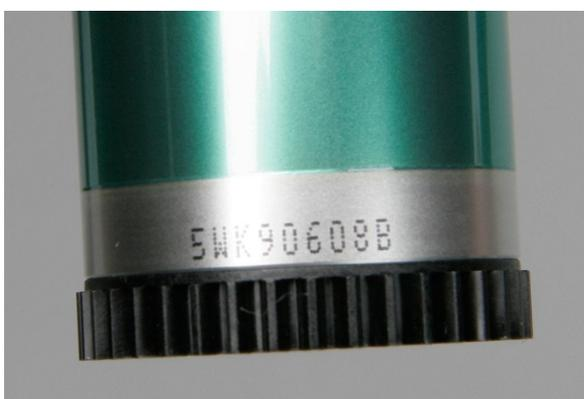
5. На поверхности барабана есть маркировка партии изготовления. Маркировка выполнена струйным принтером.
